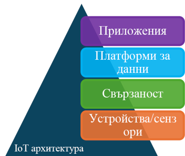
Фиг. 1. Класическата архитектура на IoT
